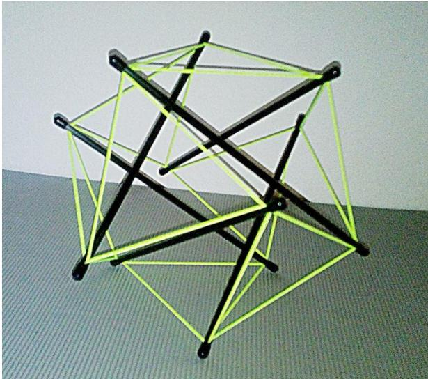
Tensegrity ist ein zusammengesetztes englisches Wort aus "tension" (Spannung) und „integrity“ (Ganzheit, Zusammenhalt). Es wird Richard Buckminster Fuller und Kenneth Snelson zugeschrieben und bezeichnet die Erfindung eines Tragwerkssystems, in dem sich Strukturen durch Druck und Spannung selbst stabilisieren.
